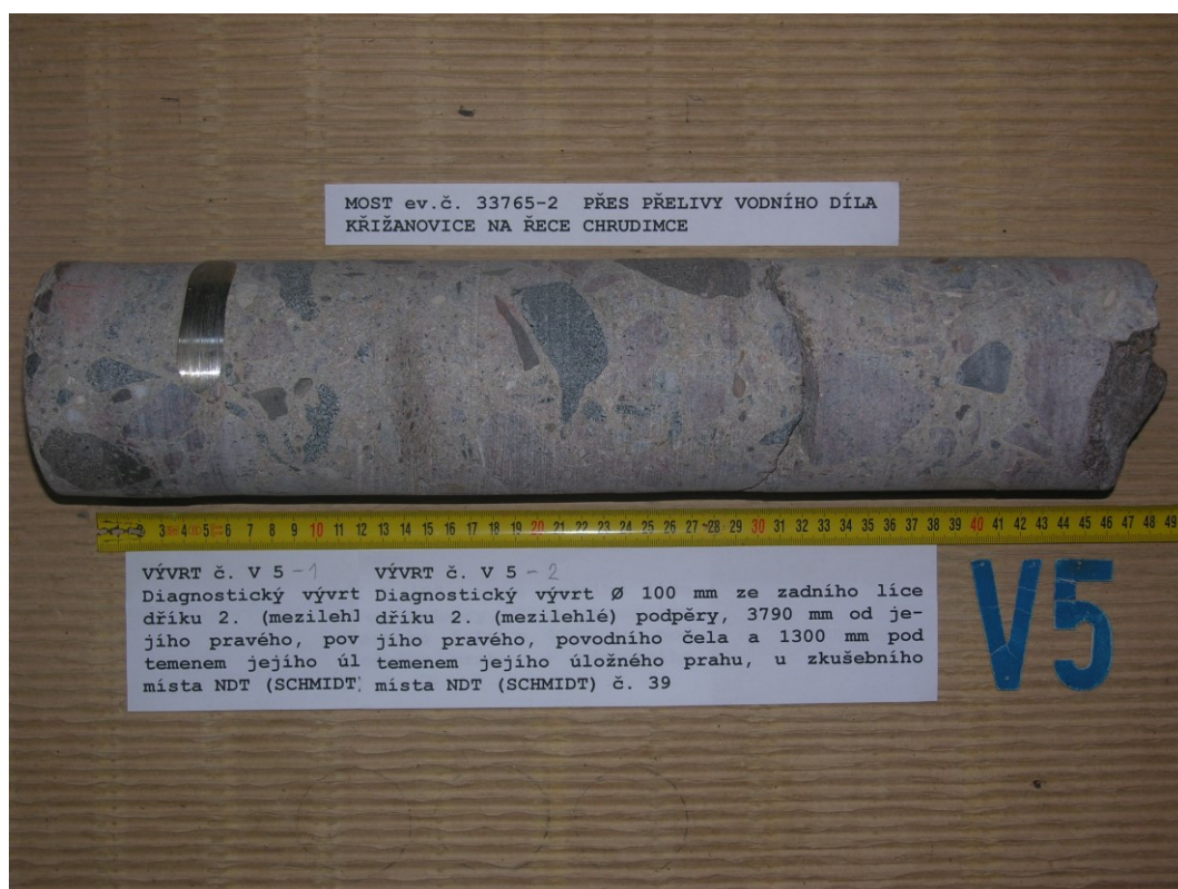
Obr. F41-6 VÝVRT č. V5. Diagnostický vývrt Ø100 mm ze zadního líce dříku 2. (mezilehlé) podpěry, 3790 mm od jejího pravého, povodního čela a 1300 mm pod temenem jejího úložného prahu, u zkušebního místa NDT (Schmidt) č.39.
