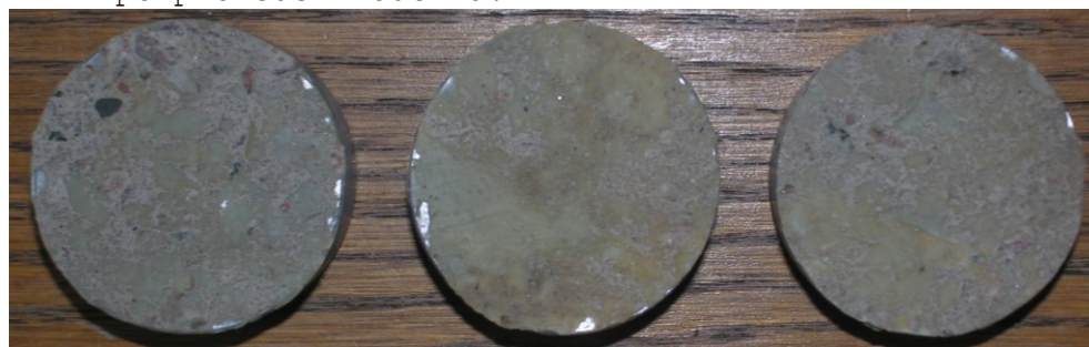
Obr.F41-212 Zkušební terče číslo 14, 61, 107 (zkušební místo 2) po provedení odtrhu.
