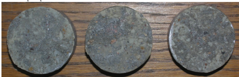
Obr.F41-219 Zkušební terče číslo 6, 29, 90 (zkušební místo 9) po provedení odtrhu.
