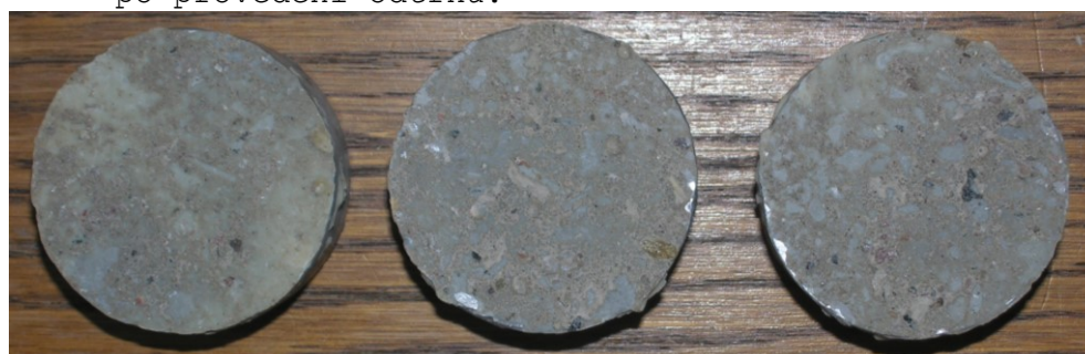
Obr.F41-215 Zkušební terče číslo 25, 27, 80 (zkušební místo 5) po provedení odtrhu.
