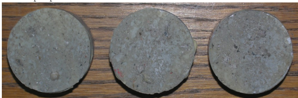
Obr.F41-217 Zkušební terče číslo 31, 65, 101 (zkušební místo 7) po provedení odtrhu.
