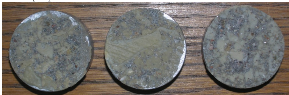
Obr.F41-220 Zkušební terče číslo 8, 39, 116 (zkušební místo 10) po provedení odtrhu.
