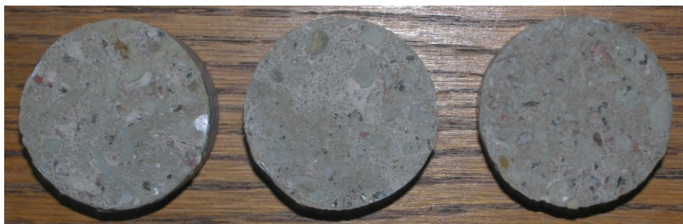
Obr.F41-216 Zkušební terče číslo 17, 44, 69 (zkušební místo 6) po provedení odtrhu.
