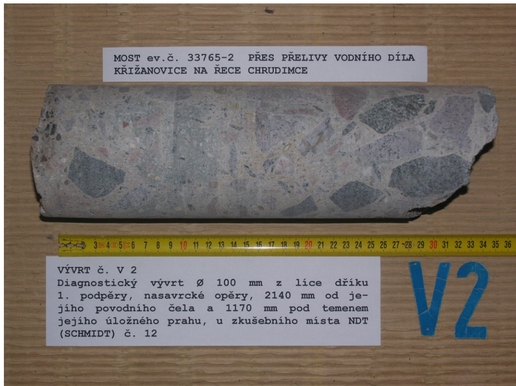
Obr. F41-2 VÝVRT č. V2. Diagnostický vývrt \varnothing 100 mm z líce dříku 1. podpěry, nasavrcké opěry, 2140 mm od jejího povodního čela a 1170 mm pod temenem jejího úložného prahu, u zkušebního místa NDT (Schmidt) č.12.
