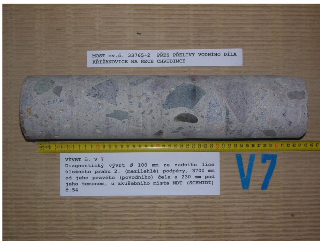
Obr. F41-8 VÝVRT č. V7. Diagnostický vývrt \varnothing 100 mm ze zadního líce úložného prahu 2. (mezilehlé) podpěry, 3700 mm od jeho pravého (povodního) čela a 230 mm pod jeho temenem, u zkušebního místa NDT (Schmidt) č.47.
