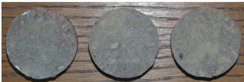
Obr.F41-211 Zkušební terče číslo 42, 117, 121 (zkušební místo 1) po provedení odtrhu.
