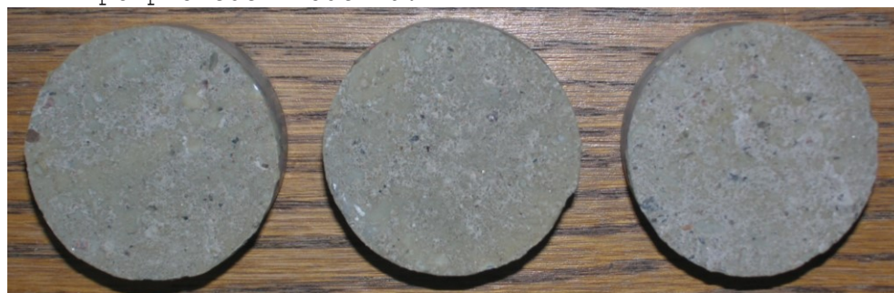
Obr.F41-213 Zkušební terče číslo 1, 19, 127 (zkušební místo 3) po provedení odtrhu.
