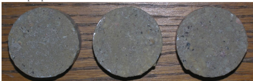
Obr.F41-218 Zkušební terče číslo 40, 137, 142 (zkušební místo 8) po provedení odtrhu.
