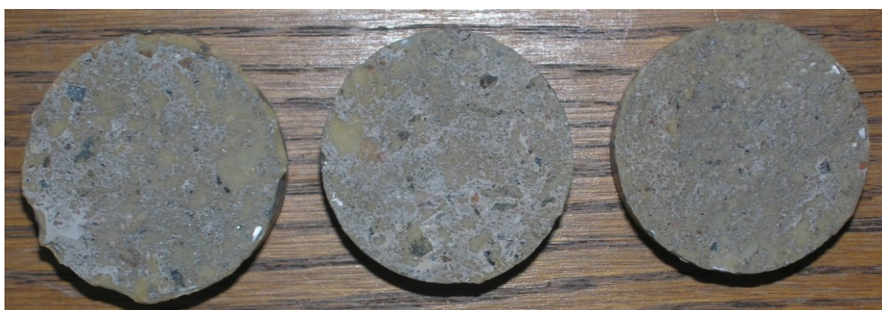
Obr.F41-214 Zkušební terče číslo 49, 122, 139 (zkušební místo 4) po provedení odtrhu.
